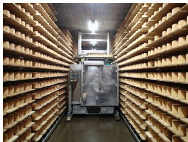
Käselager mit automatischer Schmiermaschine
